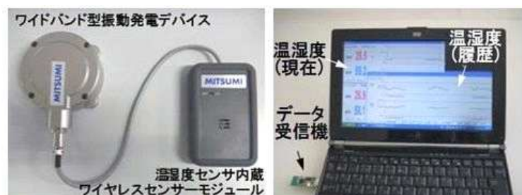
[그림3] 진동발전장치와 무선센서(좌), 온·습도관리화면 (출처 : 타케나카 기술연구소)
