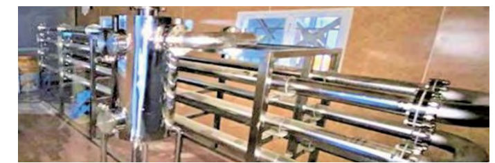
이산화탄소 포집-탄산 광물화 동시 반응 시스템(100kg-CO 2 /일)
