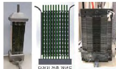
단전지 적층 개념도 SOFC 스택 설계/제작/운전 기술
