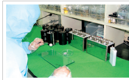
▲ 하이브리드 슈퍼캐패시터 전극 제조 (Electrode Preparation of Hybrid Supercapacitor)
