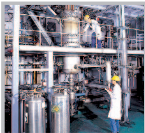
◀ IGCC용 분류층 석탄 가스화 장치 (Entrained-flow Coal Gasifier for IGCC)
