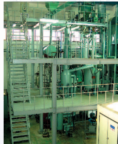
▲ 고분자폐기물의 열분해유화 시험 플랜트 (Pilot Plant for the Pyrolysis Liquefaction of Polymer Wastes)
