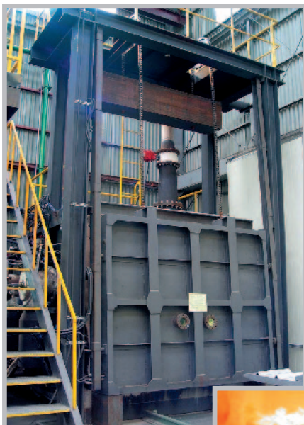
▲ 고성능단조가열로 및 화염 (Energy Saving Forging Furnace and Flame)
