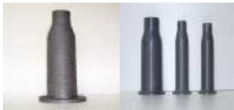
▲ 산소제조용 분리막 모듈 및 미세구조(Membrane Module for Oxygen Production and Microstructure)
