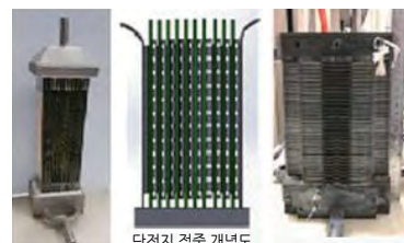
단전지 적층 개념도 SOFC 스택 설계/제작/운전 기술
