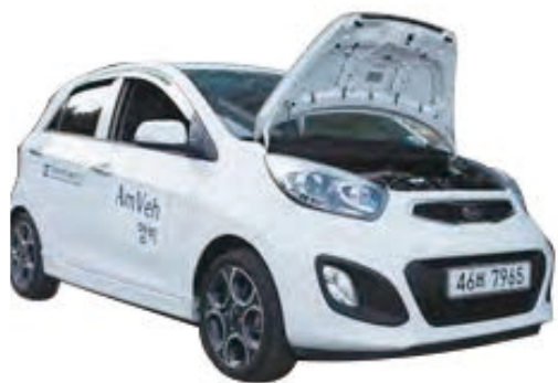
암모니아 가솔린 혼소 자동차
