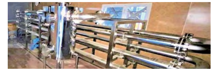
이산화탄소 포집-탄산 광물화 동시 반응 시스템(100kg-CO 2 /일)
