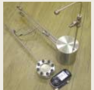
▲ 팔라듐 합금 복합막 수소정제 모듈 (Hydrogen Purification Module Using Palladium Alloy Composite Membranes)
