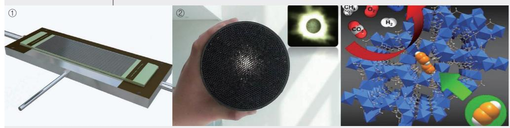
① 수소 대량생산용 고체산화물 수전해 스택 ② 300채널급 탄소섬유-탄화규소 복합소재 허니컴 ③ 금속유기복합체를 이용한 가스분리
